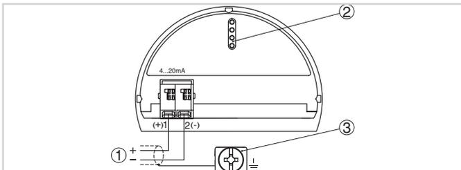
Отсек электроники и подключения (однокамерный корпус)
