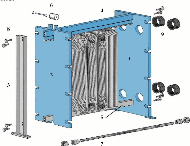
Рисунок 3.1. Конструкция теплообменника
