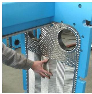
Рис 6.11. Монтаж первой пластины
