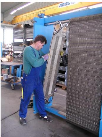
Рис 6.4. Демонтаж пластины с нижней направляющей.
