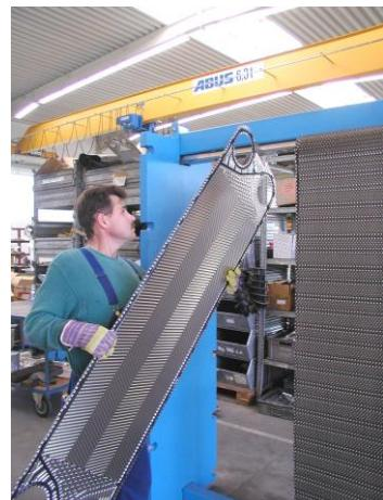
Рис 6.5. Демонтаж пластины с верхней направляющей.
