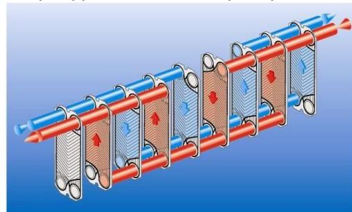
Рисунок 3.3. Многоходовая схема
