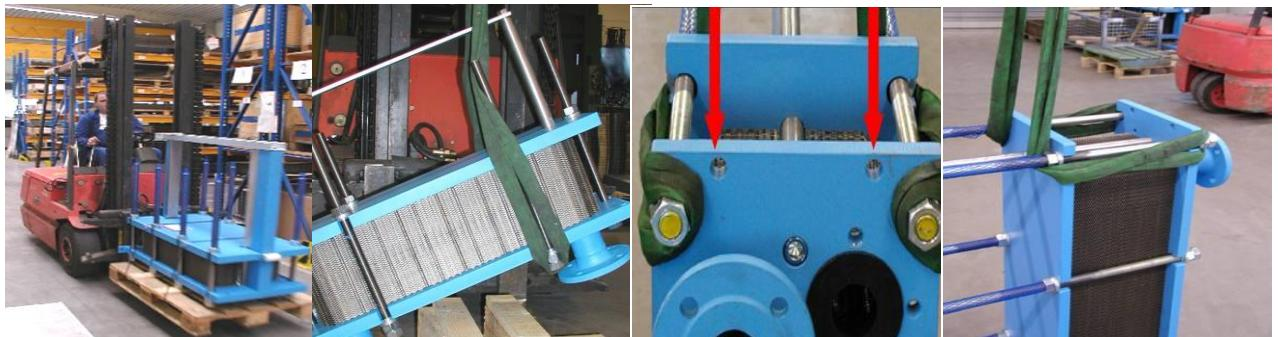
Рисунок 4.1. Транспортирование погрузчиком Рисунок 4.2. Положение строп
