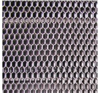
Рис 6.14. Торцевая сторона пакета пластин
