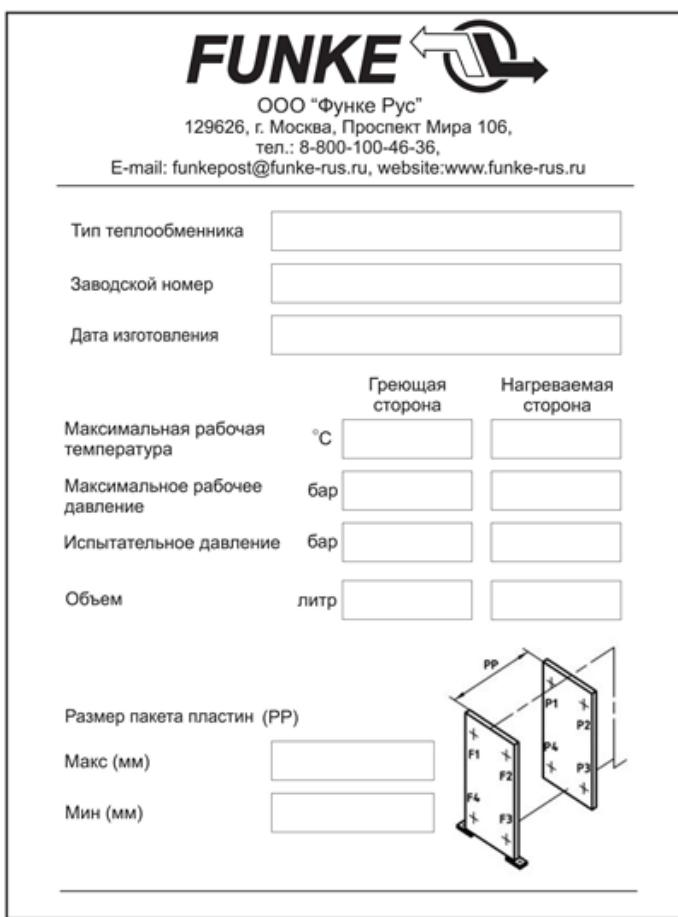
Рисунок 1.1 Принципиальная компоновка типового шильда
