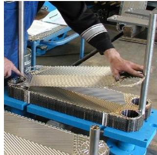
Рис 6.13. Сборка маленьких типоразмеров теплообменников
