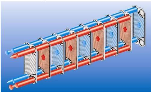
Рисунок 3.2. Одноходовая схема.
