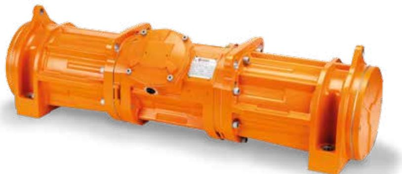
I motovibratori antideflagranti MVTX sono progettati per ambienti con atmosfere potenzialmente esplosive e sono comunemente utilizzati sui vagli. Sono caratterizzati da spessori e da giunti maggiorati antifiamma per resistere alla pressione che si può sviluppare all'interno dei motovibratori stessi ed impedire la trasmissione dell'esplosione all'ambiente circostante. La serie MVTX è caratterizzata e valorizzata dalle certificazioni UL, cUL, ATEX, IECEx e GOST.
